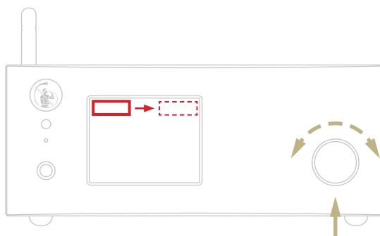
**Über die Fernbedienung:** Das Antippen der EINGABE-Taste entspricht dem Drücken des Drehknopfs, während die Tasten IN+/- dem Drehen nach rechts/links entsprechen.
